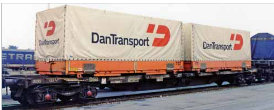
Carro Sgns danese caricato con due casse mobili telonate "DanTransport". Danish type Sgns container wagon loaded with two "DanTransport" swap bodies. Dänischer Sgns-Wagen, beladen mit zwei Planen-Wechselbehältern „DanTransport“.
