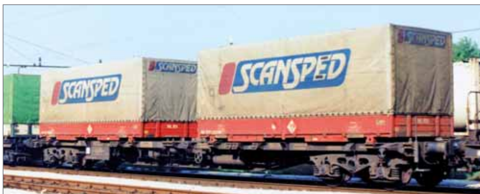
Carro Sgns danese caricato con due casse mobili telonate "SCANSPED". Danish type Sgns container wagon loaded with two "SCANSPED" swap bodies. Dänischer Sgns-Wagen, beladen mit zwei „SCANSPED“-Wechselbehältern mit Plane.
