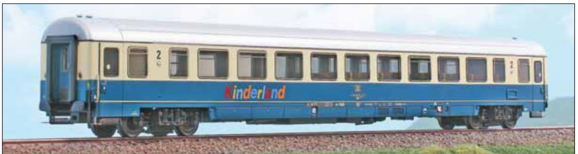
Carrozza DB Tipo Bpmz 291.3 di 2 a classe con spazio per gioco bambini. Livrea originale blu e crema DB Type Bpmz 291.3 2 nd class car, with playground space, original blue and cream livery. DB Typ Bpmz 291.3 2 nd . Klasse Wagen, Kinderland, original Lackierung.
