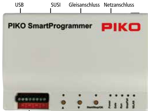
4 Anschlüsse für Sensoren (Pendelautomatik)
