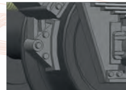
■ Bremsbacken auf Radlaufebene
