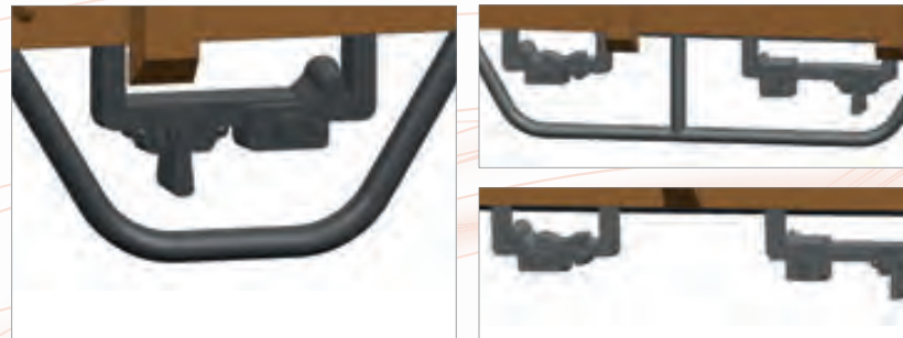
■ Bremshebel in vorbildgerechter Ausführung
