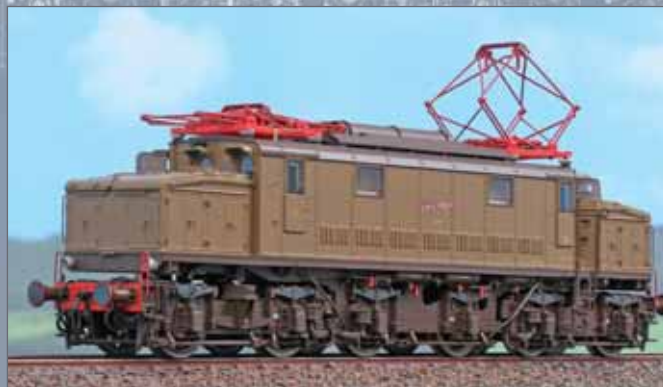
Locomotiva E. 626.313 del Deposito di Salerno, nello stato di servizio degli anni Ottanta, dotata di maglia sganciabile in corsa, utilizzata durante il servizio di spinta.
