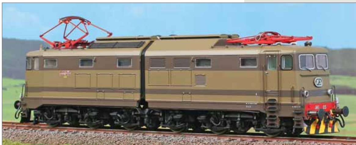
Locomotiva elettrica delle FS E.645.055 di seconda serie, livrea castano elsabella con cornice dei finestrini frontali di tipo metallico. E.645.055 Italian Railways locomotive. Second series model, two tone brown livery, with steel front windowsframe. E-Lok E.645.055 der FS, Zweite Bauserie, zweitönige braune Lackierung, Fensterrahmen aus Metall.
