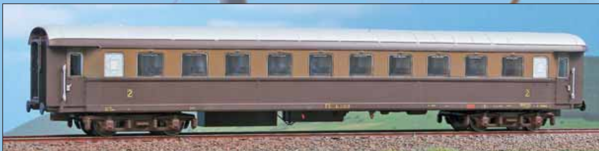
Carrozza di seconda classe Bz33000 in livrea castano/Isabella con carrelli di recupero, costruzione SIAI-Marchetti. Second class car Bz33000 in two-tone brown livery, SIAI-Marchetti builder. Zweite-Klasse-Wagen Bz 33000 in Castano/Isabella-Lackierung, von SIAI-Marchetti gebaut.
