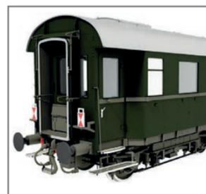
Dank des hohen Eigengewichts der Ganzstahlwagen und der Drehgestelle Bauart „Görlitz II schwer“ zeichneten sich die Wagen durch hohe Laufruhe aus. Lenz plant vier Modelle: einmal 1. Klasse und zweimal 2. Klasse sowie einen Schnellzug-Gepäckwagen
