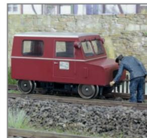
Ende der 50er bis Mitte der 60er wurden von der DB Motordraisinen beschafft. Zum Wenden wird die Draisine mit einer eingebauten Mechanik manuell (kurbeln!) angehoben und auf dem Gleis gedreht.
