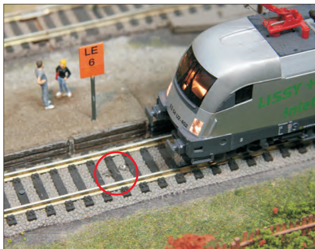
Kaum sichtbar: in das Gleis eingebaute LISSY-Empfängersensoren
