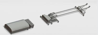
Trolleybusstangen mit Halter und Kasten
