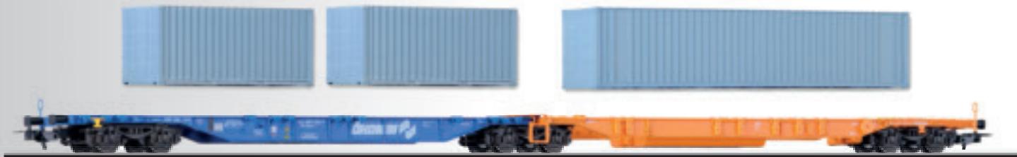
Doppeltragwagen Sdggmrss „Ökombi“ der ÖBB, beladen mit unterschiedlichen Containern Container car Sdggmrss „Ökombi“ of the ÖBB load with different containers
