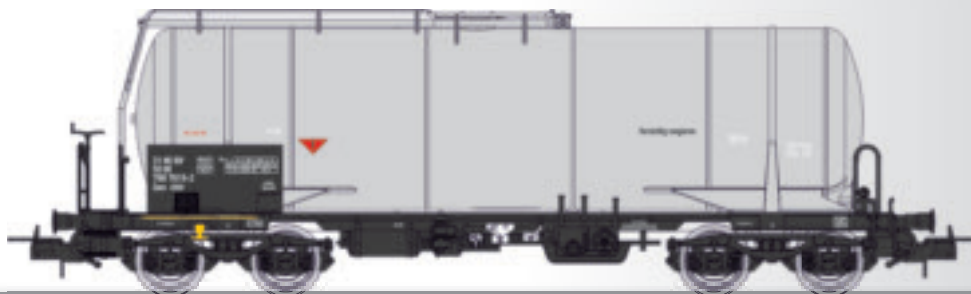
Kesselwagen Zaes 8118 „E 140“ (für Speiseöl) der DR mit Heizeinrichtung Tank car Zaes 8118 „E140“ (für Speiseöl) of the DR with heating amatures
