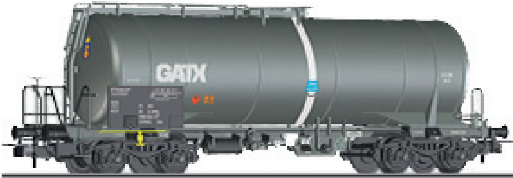
Kesselwagen Zaes „für Lebensmitteltransporte“ der GYSEV mit Heizeinrichtung Tank car Zas „for foodtransport“ of the GYSEV with heating amatures
