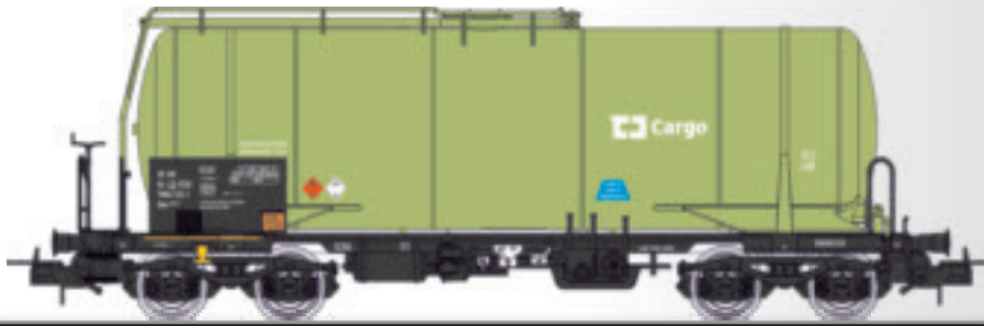
Kesselwagen Zas „ČD Cargo“ mit Heizeinrichtung Tank car Zas „ČD Cargo“ with heating amatures
