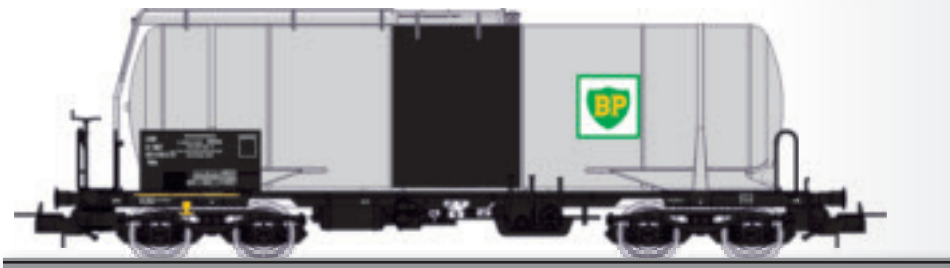
Kesselwagen Uahs „SIMOTRA/BP“ der SNCF ohne Heizeinrichtung Tank car Uahs „SIMOTRA/BP“ of the SNCF with heating amatures
