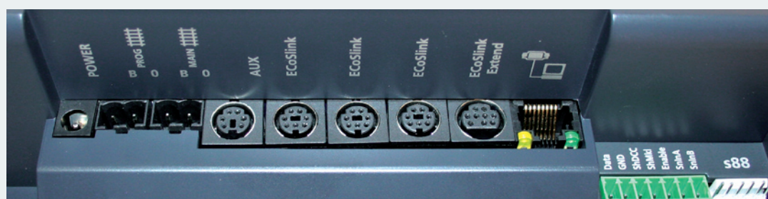
S88-Eingang ECoSniffer-Eingang DCC Booster Out Ethernet Anschluss ECoSlink Systemerweiterungsbuchse ECoSlink Systemanschlussbuchse ECoSlink Systemanschlussbuchse Hauptgleisanschluss Programmierschlüssel Power-In-Buchse ECoSlink-Erweiterungsbuchse für ECoSControl Radio
