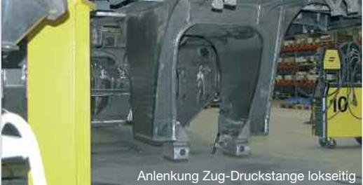
Anlenkung Zug-Druckstange lokseitig
