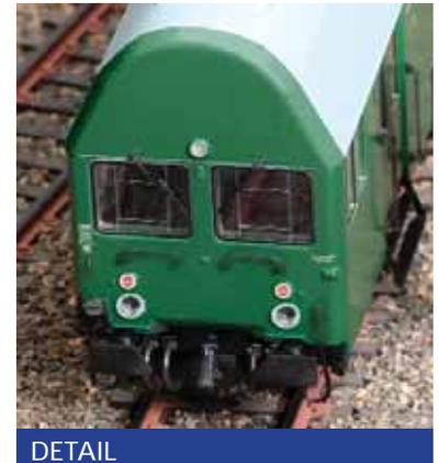
Der Steuerwagen hat Lichtwechsel weiß/rot und die Wagen sind für die Nachrüstung der Innenbeleuchtung # 56104 vorbereitet. Für den Einbau in die 5-tlg. Gliederzüge werden 5 Beleuchtungsbausätze benötigt.
