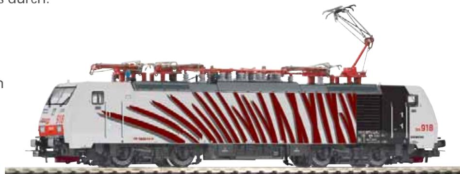
Elektrolokomotiven der BR 189 sind Hochleistungslokomotiven, die vornehmlich für den Güterzugverkehr bei der DB AG und vielen Privatbahngesellschaften von SIEMENS gefertigt wurden. Bei den Privatbahngesellschaften werden diese Loks häufig als Werbeträger beschriftet. Hier als Lokomotive mit der auffallenden Lackierung der Firma Lokomotion. Auf Seite 114
