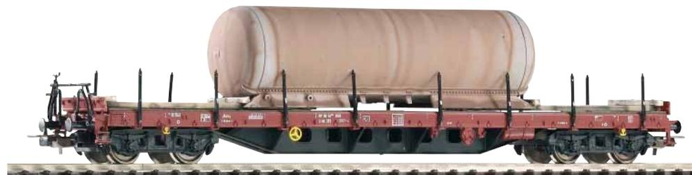
54811 Flachwagen Rs669 DB AG Ep. V, beladen mit gealtertem Druckgaskessel
