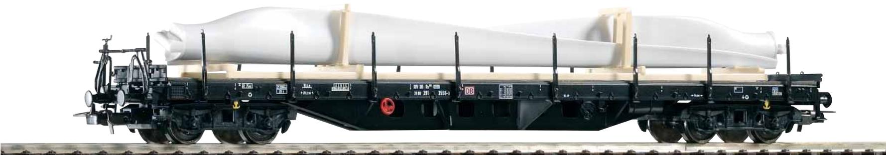
54835 Flachwagen Rs669 DB AG Ep. VI, beladen mit 2 Windrad-Flügel
