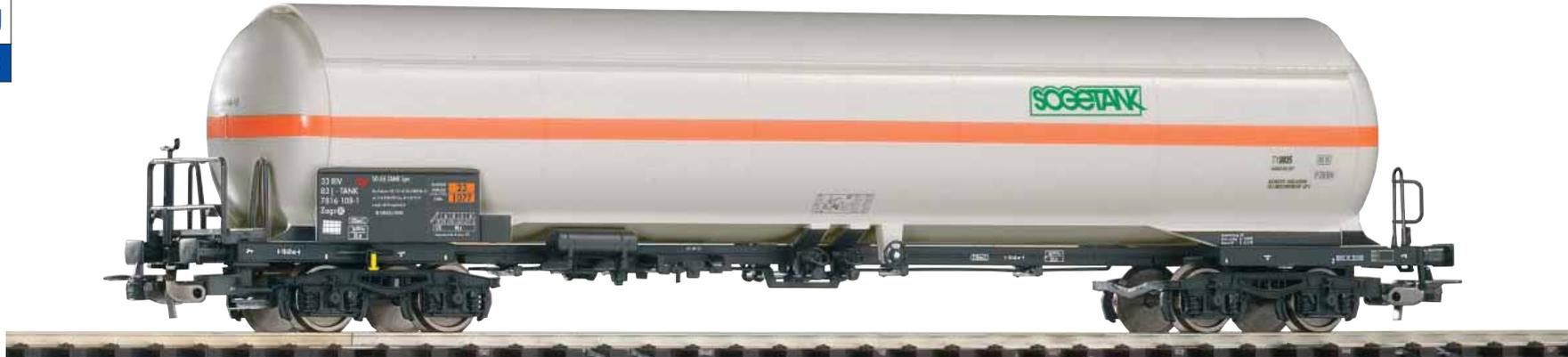
54659 Druckgaskesselwagen „SOGETANK“ DB AG Ep. VI
