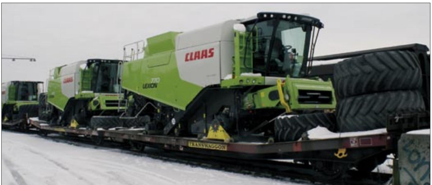
Die Laads 800B-wagen der Transwaggon werden Europaweit eingesetzt, z. B. für Transport von Mähdröser der Firma Claas. Photo: Martin Wilde.
