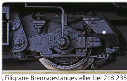
Filigrane Bremsgestängesteller bei 218 235
