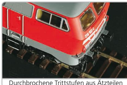
Durchbrochene Trittstufen aus Ätzteilen
