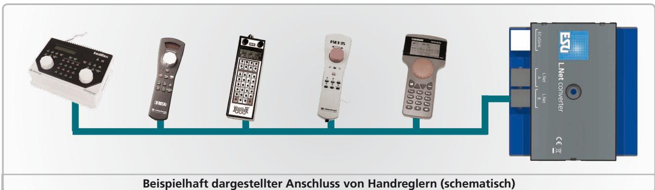
Beispielhaft dargestellter Anschluss von Handreglern (schematisch)
