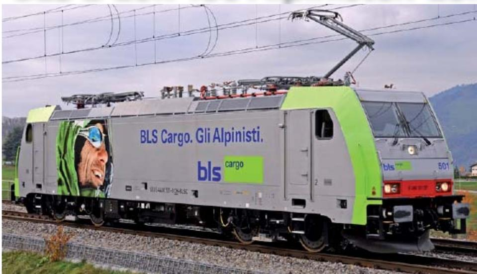
Bis Ende 2008 nahm BLS Cargo die ersten neuen Mehrsystemlokomotiven des Typs Re 486 in Betrieb. Die restlichen Lokomotiven trafen im Verlauf des ersten Quartals 2009 bei BLS Cargo ein und wurden sukzessive dem Betrieb übergeben. Die neuen Lokomotiven fallen auf: Einerseits durch die Möglichkeit, in Deutschland, der Schweiz, Italien und Österreich verkehren zu können. Andererseits durch das zweisprachige Design „BLS Cargo. Die Alpinisten.“ und „BLS.
