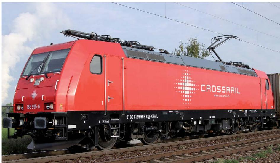
Die TRAXX F140 Lok wird für schwere Güter- und Personenzüge auf internationalen Strecken eingesetzt. Die TRAXX F140 MS ist modular aufgebaut und kann daher mit entsprechenden Modulen für verschiedene Länder konfiguriert werden. Die Crossrail mit Sitz in Muttens setzt einige TRAXX Lokomotiven im schweren Güterverkehr zwischen Holland und Italien ein. Seit Mitte 2010 trägt die BR 185 595 den aktuellen Crossrail-Anstrich und wurde auf den Namen "Ruth" getauft.
