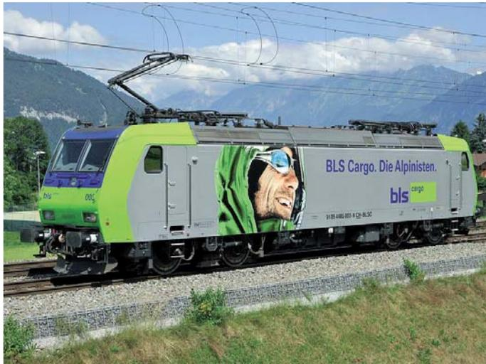
Bis Ende 2008 nahm BLS Cargo die ersten neuen Mehrsystemlokomotiven des Typs Re 486 in Betrieb. Die restlichen Lokomotiven trafen im Verlauf des ersten Quartals 2009 bei BLS Cargo ein und wurden sukzessive dem Betrieb übergeben. Die neuen Lokomotiven fallen auf: Einerseits durch die Möglichkeit, in Deutschland, der Schweiz, Italien und
