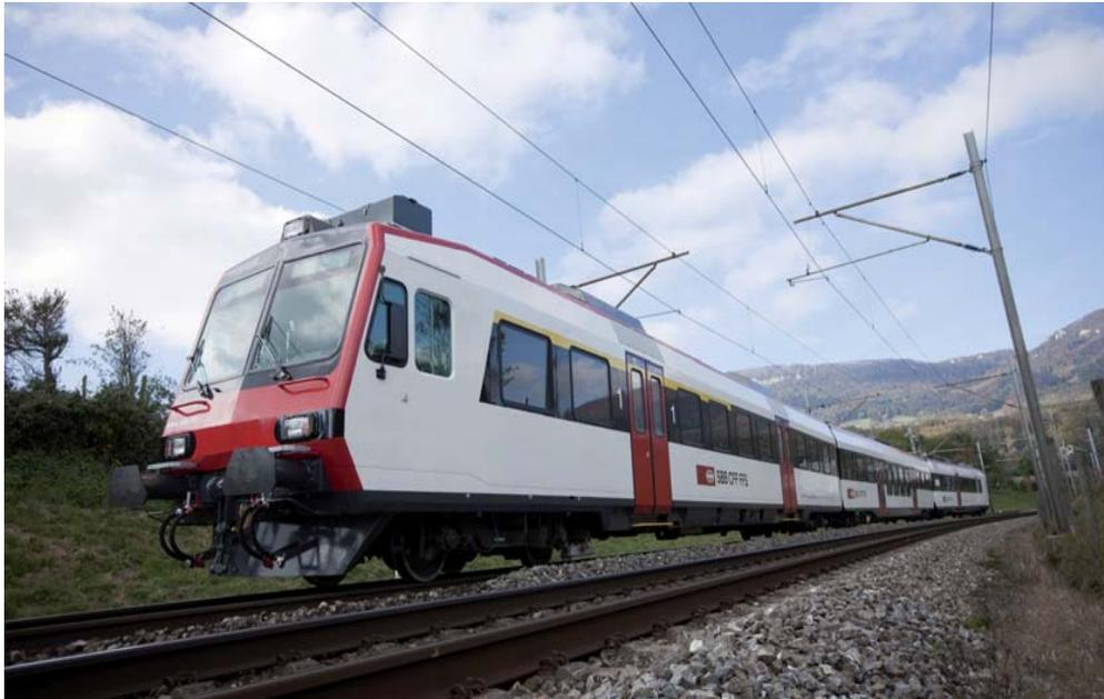
Mit der Modernisierung der NPZ-Flotte soll eine kostengünstige Alternative zum neuen Flirt angeboten werden. Die rund 20 Jahre alten Trieb- und Steuerwagen werden einem umfangreichen Refitprogramm unterzogen und mit neuen, dem Behindertengesetz entsprechenden Niederflurzwischenwagen ergänzt. Es gilt nun die bestehenden Trieb- und Steuerwagen mit den neuen Zwischenwagen so zu kombinieren, dass der Zug als zusammengehörige Einheit erkannt wird.
