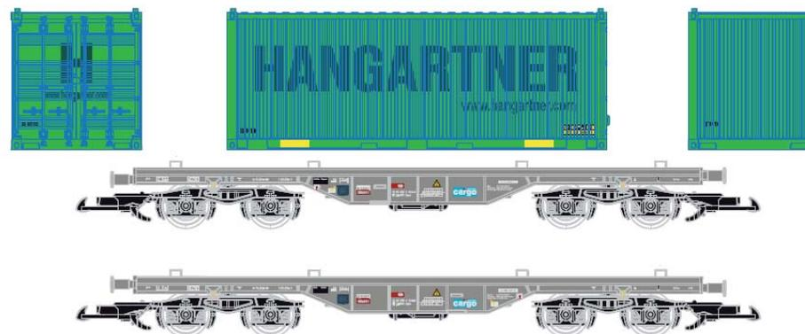
SBB Containertragwagen Typ Sgnns beladen mit einem 20' Container der Firma Hangartner. Ep.V
