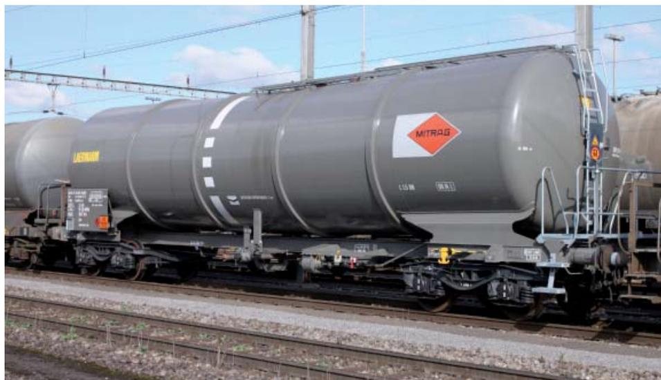
Seit 1956 vermietet die Firma MITRAG in Paradiso /TI Eisenbahnkesselwagen für die schweizerische und europäische Mineral-, Druckgas- und Chemieindustrie. Seit 2006 setzt MITRAG lärmarme Mineralölkesselwagen mit Verbundstoffbremssohlen ein.
