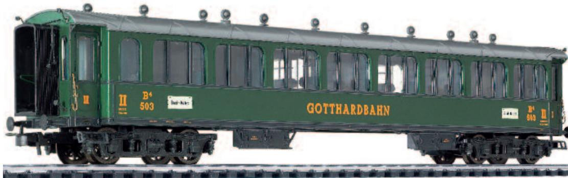
Die Gotthardbahn-Wagen sind so gestaltet, dass jeweils der Packwagen und der Schnellzugwagen AB4ü an einem Ende einen eingeschobenen Faltenbalg haben, an allen anderen Wagenenden aller Wagen sind ausgezogene Faltenbälge montiert. Damit ergibt sich ein geschlossenes Wagenbild, ohne dass vom Modellbahner die Faltenbälge ummontiert werden müssen.
