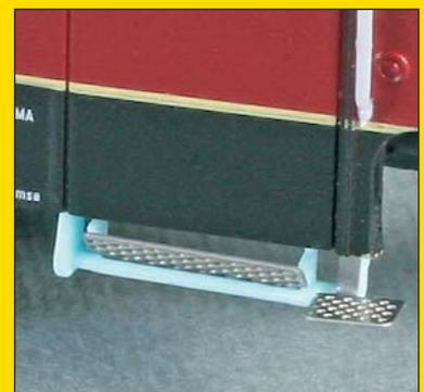
Selbstverständlich sind die federnde Puffer und freistehende Handgriffe, der obere Wulst der Faltenbälge ist durchgehend perforiert. Die Trittbleche sind aus durchbrochenem Metall separat angesetzt.
